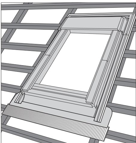
Instalați rama de etanșare conform instrucțiunilor de montaj
